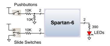
PushbuttonsSlide SwitchesLEDsBTNU: E4SW0: U7LD0: V15BTND: F5SW1: V7LD1: N12
